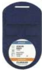
Dosimètre de criticité intégrant IPLUS et Neutrak
